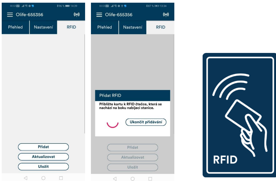
Obrázek 13: RFID menu pro přidávání karet + symbol na stanici ke kterému se přikládají karty a čipy
